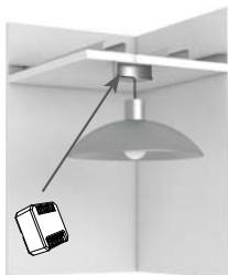
montáž do krytu svítidla
