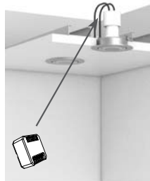
montáž do podhledu
